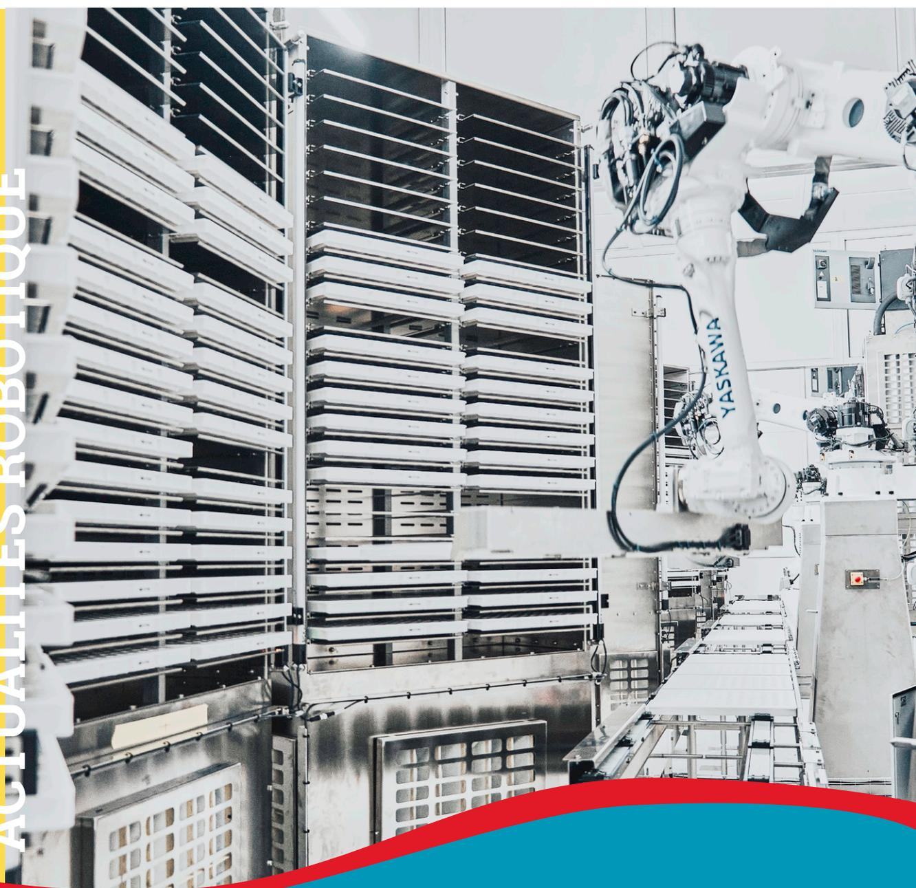
Pour doubler la production de chocolat d'un client brésilien, une nouvelle installation de refroidissement a été mise en place. La nouvelle ligne de production a été équipée de cellules de refroidissement robotisées d'un nouveau genre. Au milieu de tout cela, le robot GP50 de Yaskawa.
